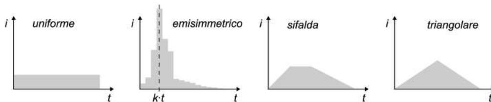
Figura 12: Esempi di forme di diversi ietogrammi sintetici
