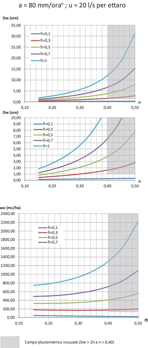
Figura 11 – Grafici della durata  $D_w$  (eq. 12'') e del volume specifico critico di invaso  $w_o$  (eq. 13'') in funzione di  $n$ , per  $a=100$  mm/ora e per  $u = 20$  l/s per ettaro
