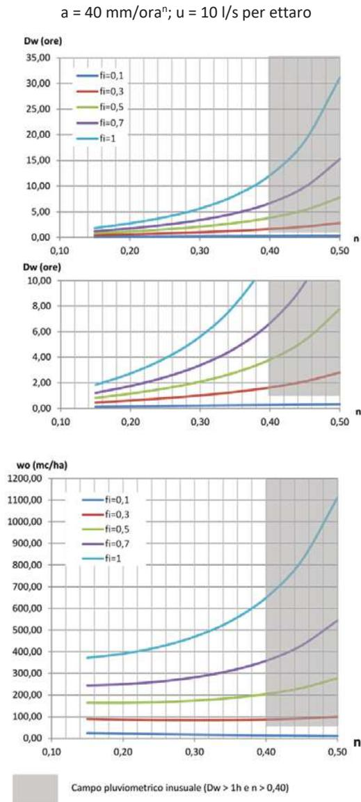
Figura 5 – Grafici della durata  $D_w$  (eq. 12”) e del volume specifico critico di invaso  $w_o$  (eq. 13”) in funzione di  $n$ , per  $a=60$  mm/ora e per  $u = 10$  l/s per ettaro
