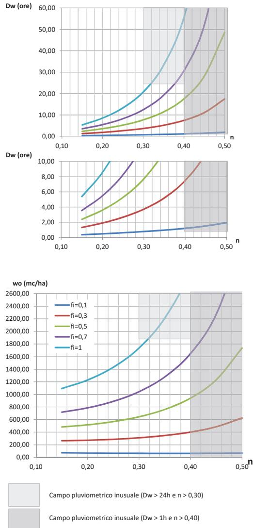
Figura 8 – Grafici della durata  $D_w$  (eq. 12'') e del volume specifico critico di invaso  $w_o$  (eq. 13'') in funzione di  $n$ , per  $a=40$  mm/ora e per  $u = 20$  l/s per ettaro
