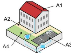
**Figura 1: distribuzione delle superfici secondo l'ipotesi progettuale (A1: tetti e terrazzi, A2: pavimentazioni semipermeabili, A3: pavimentazioni impermeabili; A4: verde collettato).**
