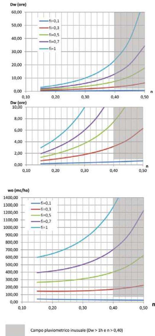
Figura 6 – Grafici della durata  $D_w$  (eq. 12'') e del volume specifico critico di invaso  $w_o$  (eq. 13'') in funzione di  $n$ , per  $a=80$  mm/ora e per  $u = 10$  l/s per ettaro
