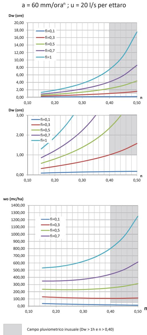
Figura 10 – Grafici della durata  $D_w$  (eq. 12'') e del volume specifico critico di invaso  $w_o$  (eq. 13'') in funzione di  $n$ , per  $a=80$  mm/ora e per  $u = 20$  l/s per ettaro
