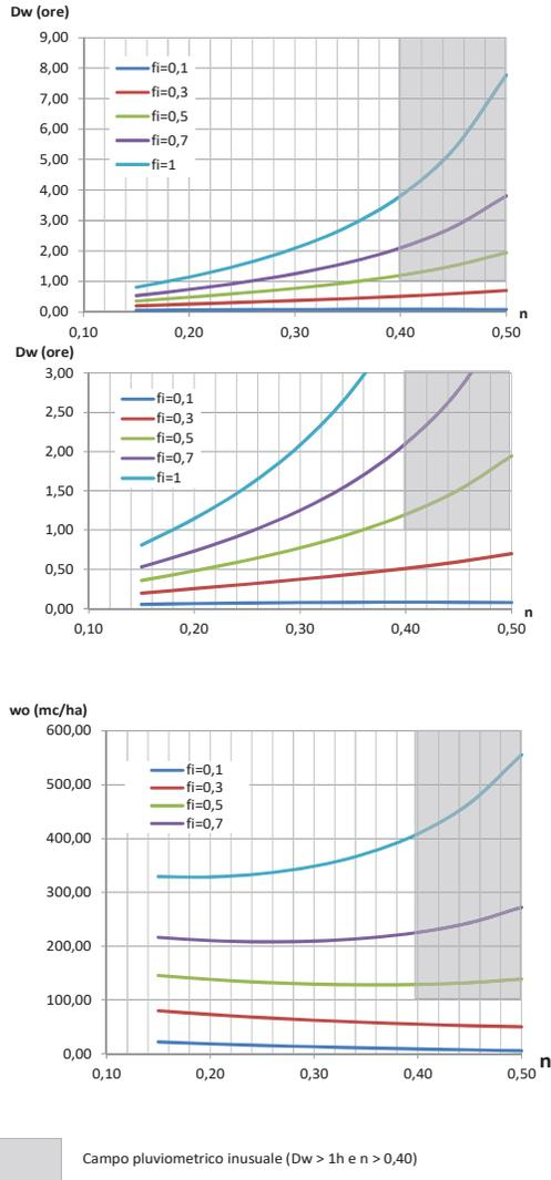
Figura 9 – Grafici della durata  $D_w$  (eq. 12'') e del volume specifico critico di invaso  $w_o$  (eq. 13'') in funzione di  $n$ , per  $a=60$  mm/ora e per  $u = 20$  l/s per ettaro
