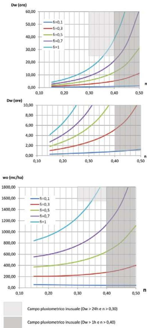
Figura 7 – Grafici della durata  $D_w$  (eq. 12'') e del volume specifico critico di invaso  $w_o$  (eq. 13'') in funzione di  $n$ , per  $a=100$  mm/ora e per  $u = 10$  l/s per ettaro
